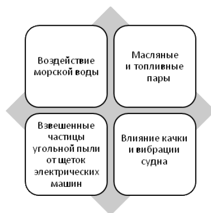
Рис. 2. Виды внешнего воздействия на электротехническую аппаратуру (составлено автором 6 )
